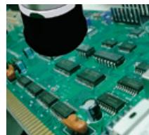
プリント基板の部品の欠落や、ショートやはんだブリッジの検査
